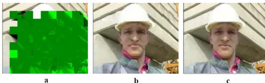
Obr. 5.11 Obnova chýbajúcich makroblokov v snímke typu I (a) použitím algoritmu b, kopírovania bez kompenzácie pohybu c, kopírovania s kompenzáciou pohybu založenom na metóde zhody hrán
