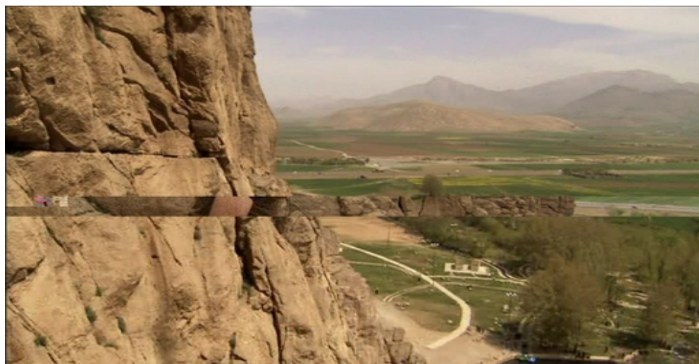
Obr. 6.7 Príklad poškodenia obrazu spôsobeného zmenou poradia paketov
