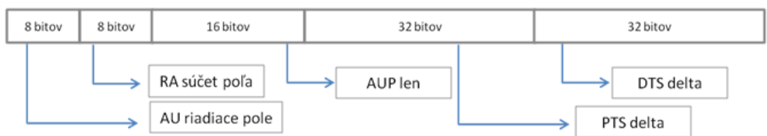
Obr. 6.25 Štruktúra VC-1 AU paketu
