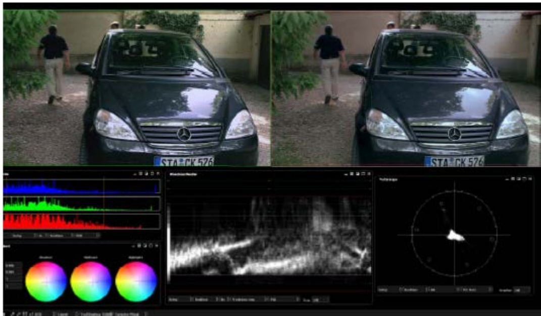
Obr. 7.10 Príklad stereo farebného porovnávania a triedenia pomocou profesionálneho postprodukčného programu [1].
